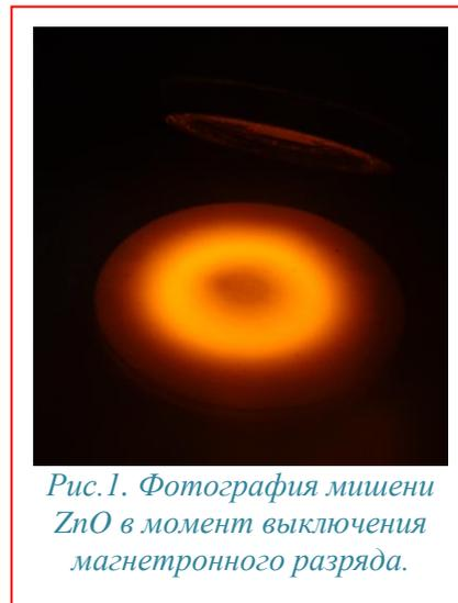
Рис.1. Фотография мишени ZnO в момент выключения магнетронного разряда.
