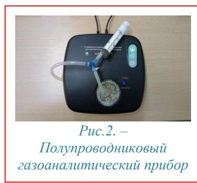
Рис. 2. – Полупроводниковый газоаналитический прибор
