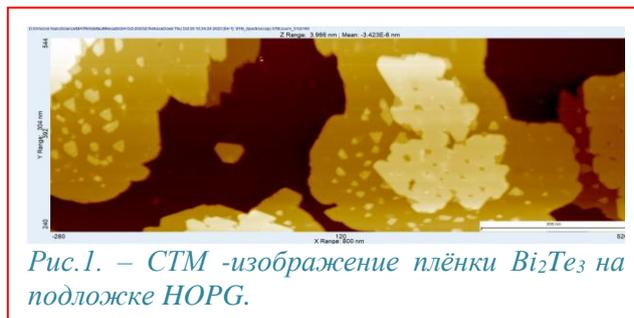
Рис.1. – СТМ -изображение плёнки  $\text{Bi}_2\text{Te}_3$  на подложке НОРГ.
